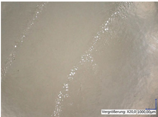
Abbildung 16a: LABS-Fehler verursacht durch aus O-Ring herausgelöste lack- benetzungsstörende Substanzen, Aufnahme mit Auflicht
