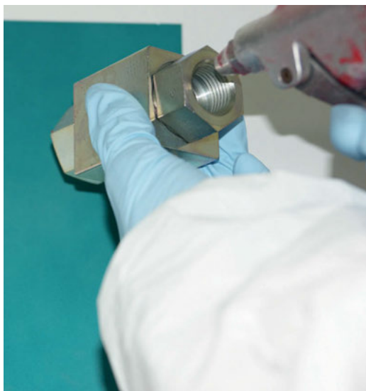
Abbildung 7: Abblasen einer Innenfläche auf die Prüfunterlage
