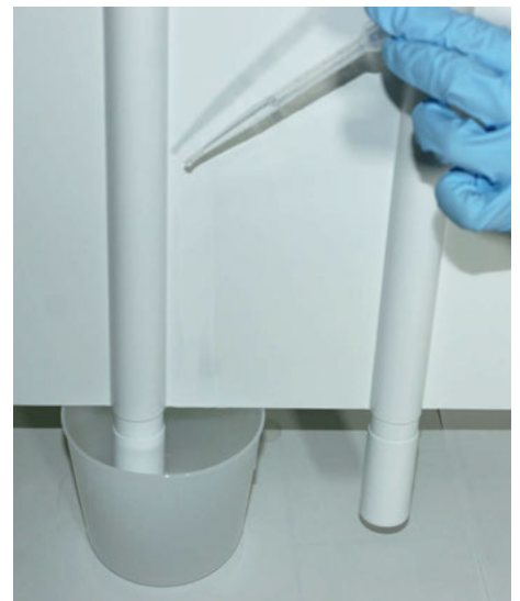
Abbildung 3: Rohr in Becher abspülen
