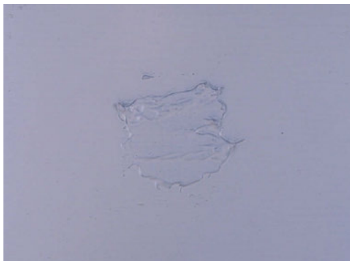
Abbildung 21: Überlackiertes Schmierfett (kein LABS-Fehler)
