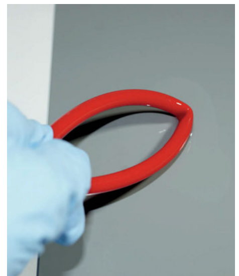
Abbildung 6: Schlauch/Kabel in Lösemittel auf Prüfunterlage reiben
