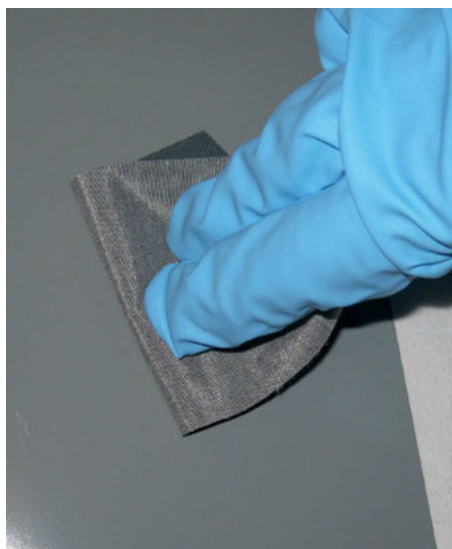
Abbildung 5: Textil auf Prüfunterlage reiben
